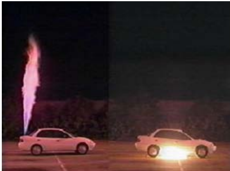
写真2 - Time 0 min, 3 seconds - 燃料に点火開始 水素燃料流量52Nm 3 /min. ガソリン燃料流量680cc/min.
