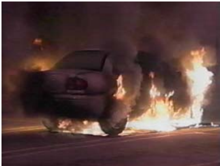
写真 5 - Time: 2 min, 20 sec – 火炎が中に侵入する前
