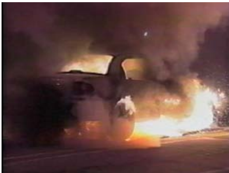
写真 6 - Time: 2 min, 20 sec – 内部に延焼,トランクの蓋の 周囲に火炎が届いた。
