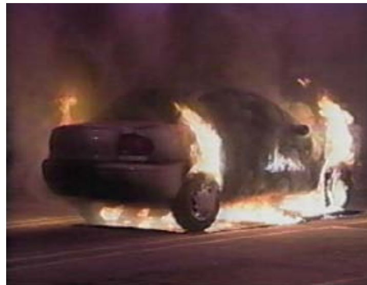
写真7 - Time: 2 min, 40 sec – 運転席後部のタイヤがはじける前
