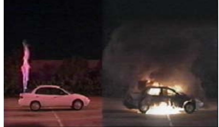
写真3 - Time: 1 min, 0 sec - 水素は、勢いが弱まっている, ガソリン車は、勢いが大きくなり始めた
